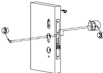
7: 接上前面板和锁体上的连接线, 对好孔位装好前面板和后面板并用面板螺丝锁好
