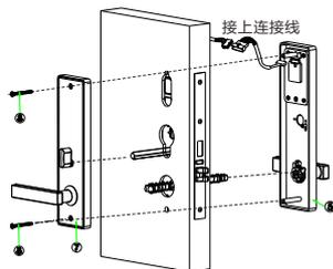
4: 将锁体装入开好门孔的门中, 并用锁体螺丝固定好; 套上侧饰板并用螺丝锁好
