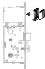
5: 在前面板对准孔位装入锁头从后面板用螺丝将锁头锁好
