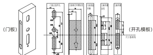
3: 将锁体装入开好门孔的门中，并用锁体螺丝锁好；
