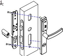
5: 装入锁头后使用锁头固定螺丝锁好，安装后面板，注意孔位对应，并用后面板螺丝锁好
