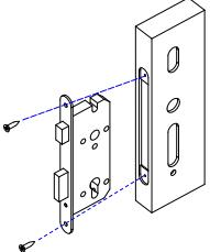
4: 安装前面板和电机底座，注意孔位对应，用电机底座螺丝锁好，同时装入锁头
