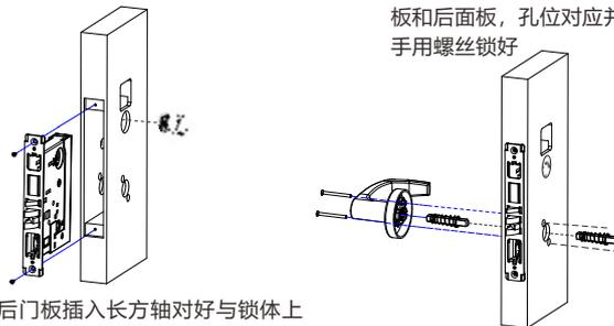
5: 在后门板插入长方轴对好与锁体上的孔位, 装上后面板反锁旋钮并用螺丝锁好
