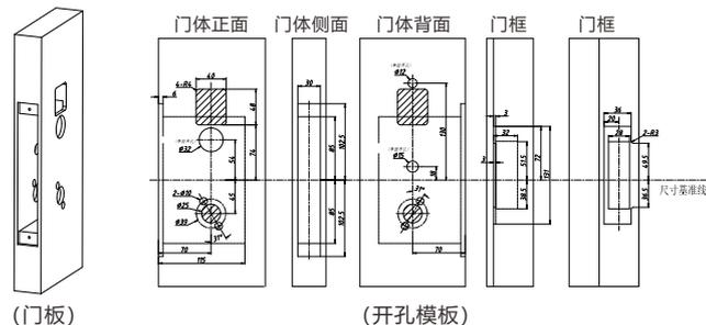
3: 将锁体装入开好的门孔中, 并用锁体螺丝锁好, 同时装入锁头
