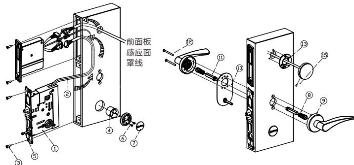
4：安装前面板和后面板如下图，分别在前面板装入短方轴对好锁体对好孔位，套上前把手。在后面板先装上底座同时插入短方轴，最后套上后把手并用面板固定螺丝锁好。前面板装上感应面罩底座并用螺丝锁好，最后套上感应面罩并在面罩侧下方用螺丝锁好。
