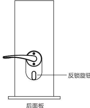
3-2：房内反锁：旋转后面板的反锁旋钮可实现反锁功能
