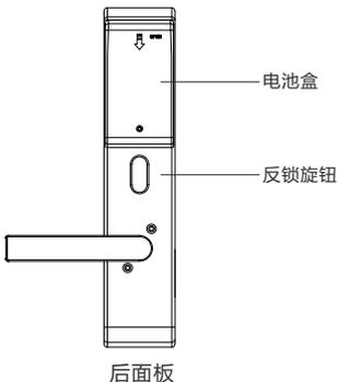
3-2: 房内反锁: 旋转后面板的反锁旋钮可实现反锁功能
