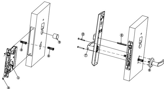
6: 对好门板上的孔位装入前感应面罩, 在后面板上套入电池盒并用长杆螺丝锁好, 装入电池扣上后盖并用螺丝锁好。
