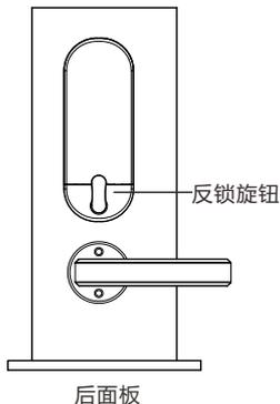
3-2: 房内反锁: 旋转后面板的反锁旋钮可实现反锁功能
