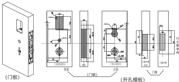
3: 将锁体和电池盒装入开好的门孔中,并用锁体固定螺丝锁好,并装入锁头。
