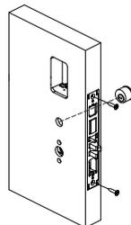
4: 安装前面板底座和前面罩,用对应的螺丝锁好;将前面板连接线和锁体连接线与后面板上的3根线——对应连接好,在后门板上插入小方轴,注意对好小方轴与锁体上的孔洞和后面板上反锁旋钮的孔洞,将后面板底座和后面板装上门板并用螺丝锁好。最后装入4颗电池套上电池盖,并在电池盖顶端用螺丝锁好。
